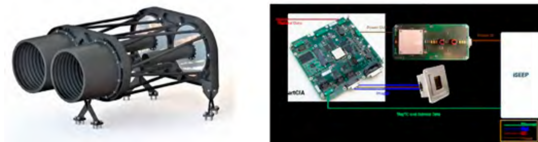
Figura 1. Modelo 3D de la optomecánica de iSIM-170 (izquierda) y arquitectura de la electrónica de iSIM-170 para el IOD (derecha).
