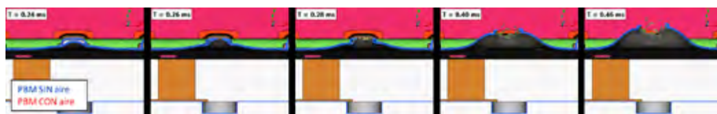
Figura 1. Comparativa de resultados de simulación de la explosión de una mina enterrada mediante PBM con y sin aire del entorno.
