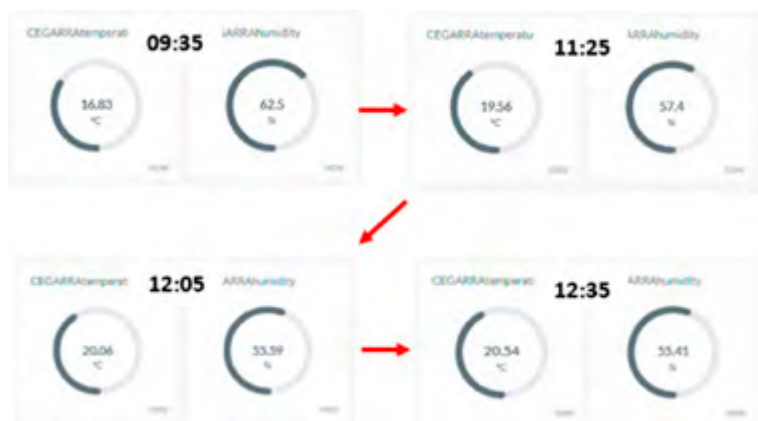
Figura 7. Lecturas proporcionadas por sensor de temperatura y humedad.
