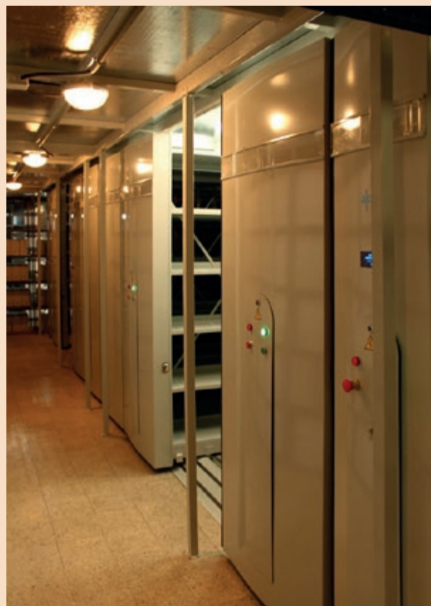
Armarios compactos eléctricos de nueva incorporación
