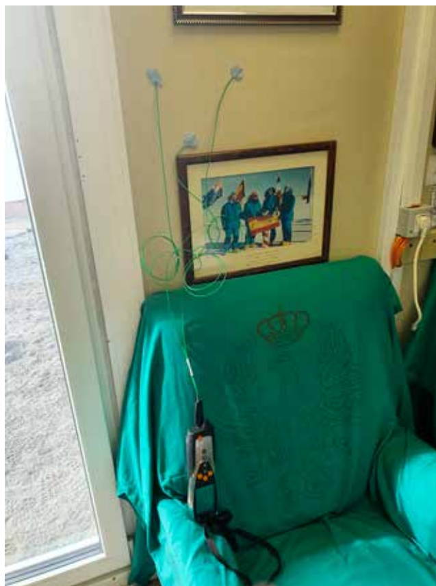
Figura 4. Colocación de termopares en la realización del ensayo.
