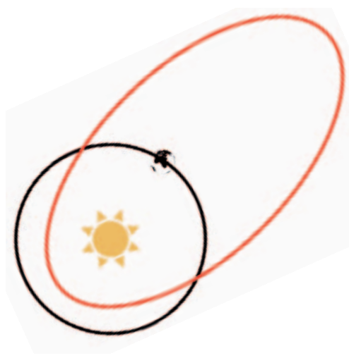
Ilustración 8. Representación esquemática de las órbitas de los asteroides Apolo (no a escala). (Elaboración propia)
