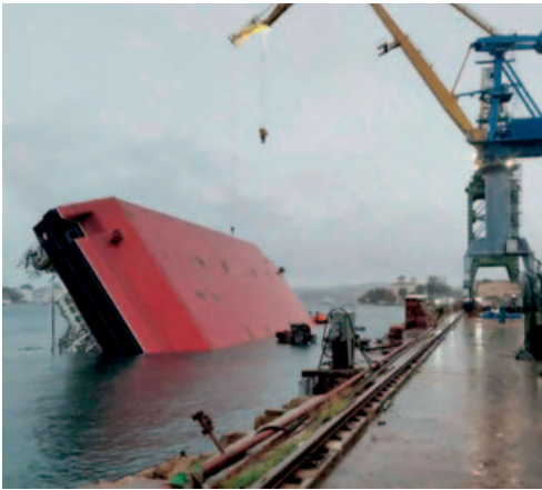
Grúa PK-700 en construcción volcada en Yuzhnaya, Sebastopol. (Imagen facilitada por el autor)
