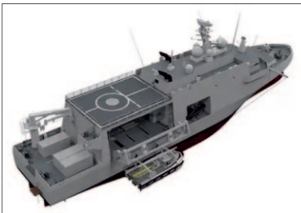
Los futuros buques nodriza de MCM dispondrán de compartimentos multimitisión para operaciones con vehículos aéreos, de superficie y submarinos no tripulados (UAS, USV y UUV respectivamente). (Fuente: Navantia)
