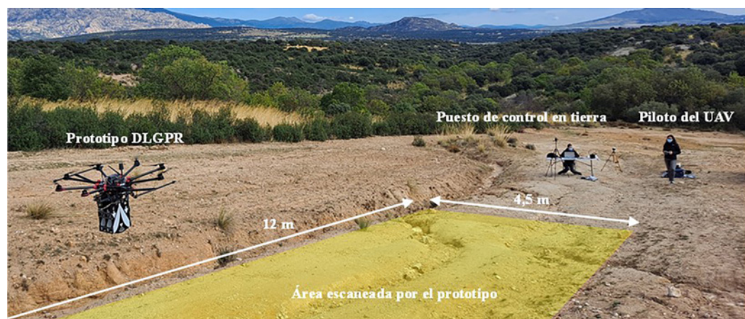
Figura 2. Fotografía de uno de los vuelos realizados durante las pruebas de validación de octubre de 2021. La zona escaneada corresponde a un tramo en cuesta y de relieve irregular de una pista de tierra
