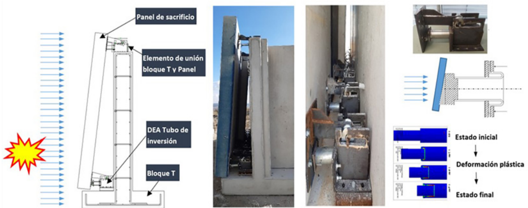
Figura 4. Solución BLADE basada en tubos de inversión
