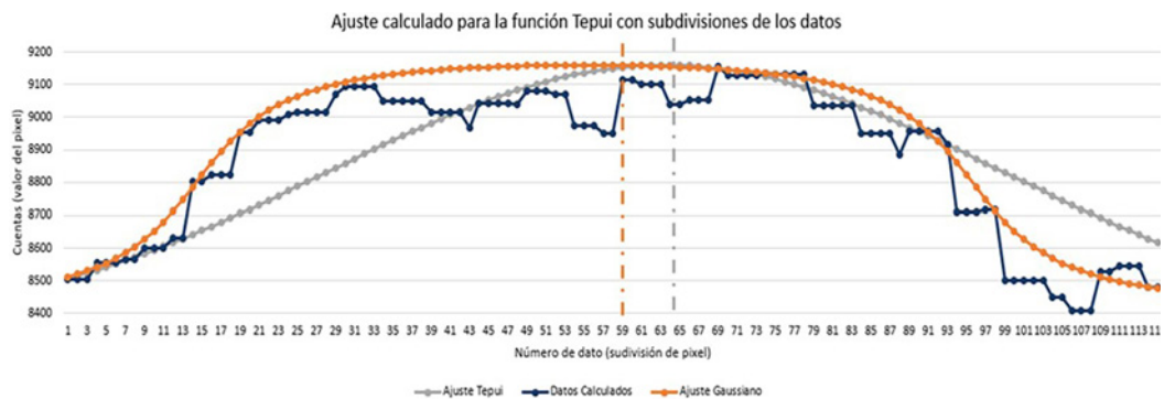
Figura 4. Ajuste de una gaussiana y una función «Tepui» sobre los datos de una traza con diferentes inclinaciones e subida y bajada
