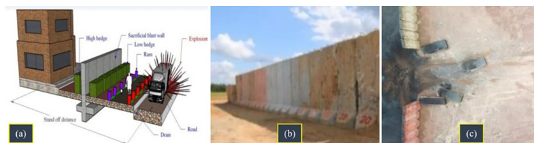
Figura 1. (a) Esquema de ataque con coche bomba, (b) Barrera T perimetral, (c) Rotura de la barrera tras un ataque de coche bomba
