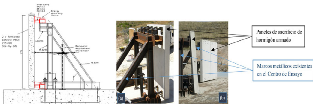
Figura 5. Sistema BLADE y ensayos de caracterización. (a) Tubos de inversión y (b) tubos huecos
