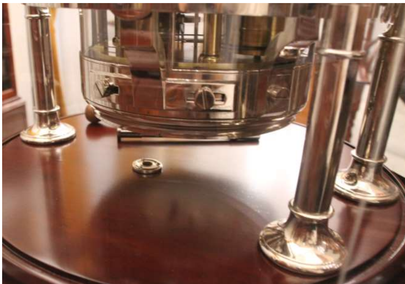
Fig. 15. Detalle del mortero y toma de cuerda del cronómetro astronómico n.º 2137. © Pablo Bernal Sánchez
