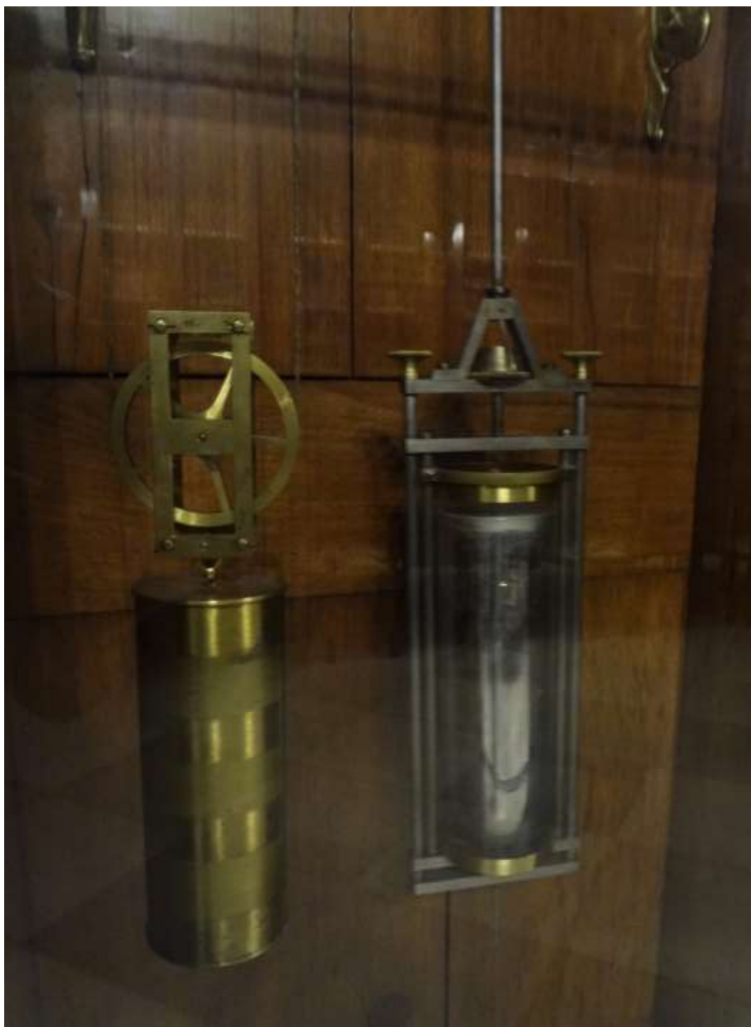
Fig. 9. Vaso de mercurio y péndulo del reloj de péndulo n.º 4521. ® Pablo Bernal Sánchez
