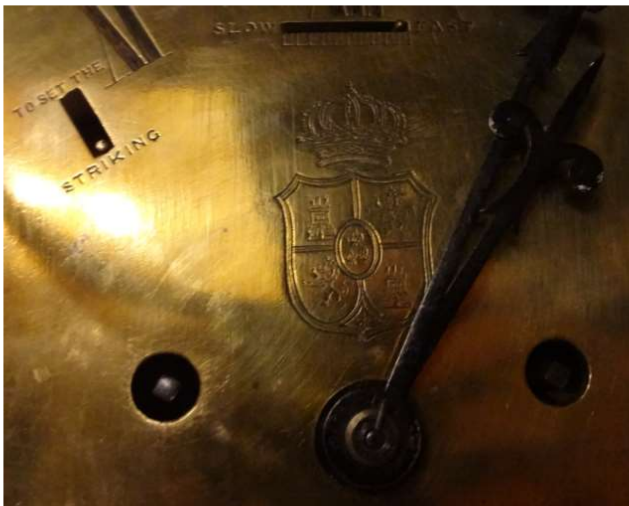
Fig. 12. Detalle de escudo, agujas y bocallaves del reloj de bitácora n.º 5340. ® Pablo Bernal Sánchez
