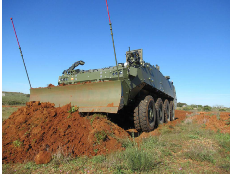
Vehículo de combate de zapadores (VCZ) Dragón 8x8
