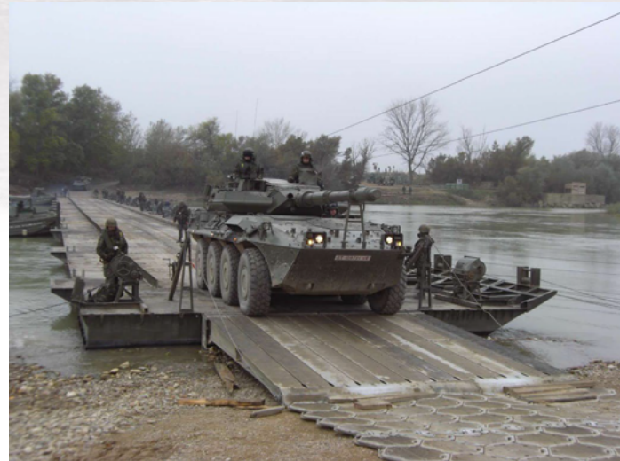
PUENTE SOBRE TABLERO FLOTANTE PTF MAN
