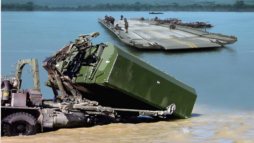
IMPROVED RIBBON BRIDGE (IRB) LANZAMIENTO DE UN PONTON DE CENTRO, AL FONDO UNA COMPUERTA CON DOS EMBARCACIONES DE EMPUJE. FUENTE: GENERAL DYNAMICS EUROPEAN LAND SYSTEMS (GDELS)
