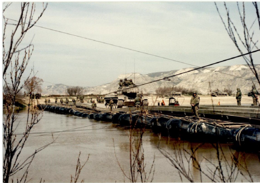
PASO DE RÍOS SOBRE PUENTE PF-50
