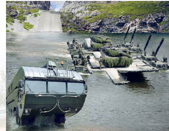
VEHÍCULO ANFIBIO M3. PLEGADO Y COMO COMPUERTA DE 4 VEHÍCULOS. FUENTE: GENERAL DYNAMICS EUROPEAN LAND SYSTEMS (GDELS),
