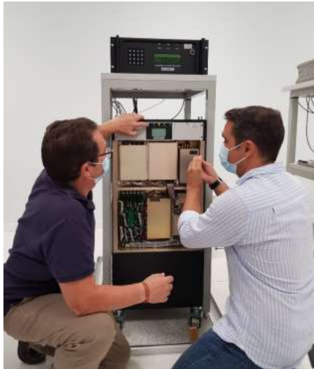
Figura 4.2: Ajuste mecánico del oscilador de cuarzo de bajo ruido del máser de hidrógeno activo principal.
