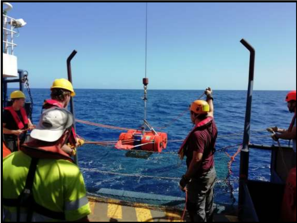
Fig. 3.14. Foto del despliegue de un OBS perteneciente a la Red FOMAR.
