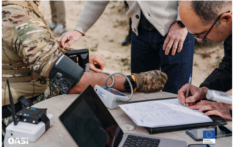
Imagen 1. Toma de datos de parámetros fisiológicos con equipos médicos de referencia para evaluación del rendimiento de los sensores integrados en el sistema WEMOR, realizada por personal médico sanitario durante las pruebas ALPHA. (Fuente: propia)
