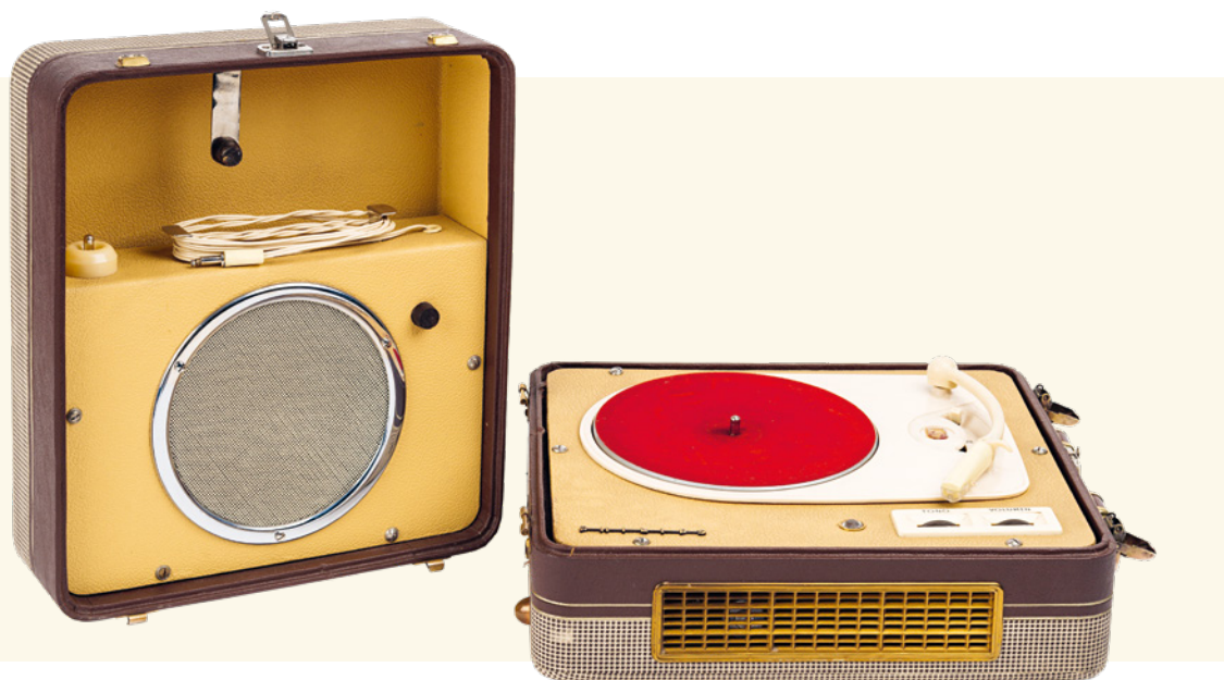
^ Fig. 7. Tocabiscos de maleta con amplificador y altavoces, modelo electrófono AG-9144 de Philips Ibérica, S. A. E. COPRESA, Madrid y Barcelona, ca. 1956. Fueron muy populares, especialmente al principio de la década de los años sesenta. Este modelo incorpora un altavoz en la tapa. BNEM, CE2728.
