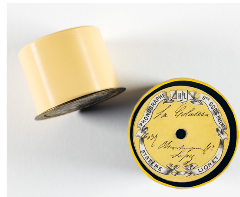
► Fig. 4. Cilindro fabricado en celuloide por Henry Lioret, entre 1897 y 1900. Contiene La calesera , de Sebastián Iradier y Bouligny. BNE, CL/202.
